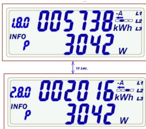
Die Anzeige wechselt alle 10s zwischen importierter (1.8.0) und exportierter (2.8.0) Energie. Die aktuelle Zählrichtung erkennt man am Symbol -A oder +A
